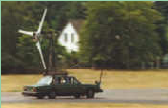
Abb.: Testfahrten mit Rotoraufsatz auf dem ehemaligen Flugplatz Gatow
